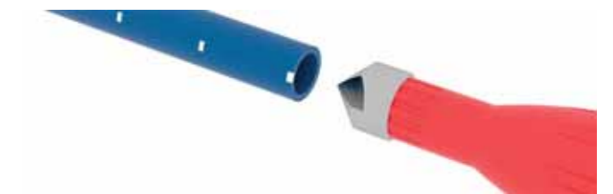
Wewnętrzna krawędź rury jest lekko fazowana ręcznym gratownikiem na głębokość ok. 1 mm.
