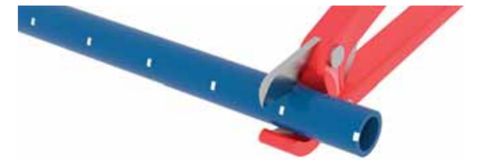
Rurę tnij się nożyczkami prostopadle do osi przewodu rurowego. Aby zapobiec splaszaniu się rury, zaleca się obracanie jej nożyczkami.
