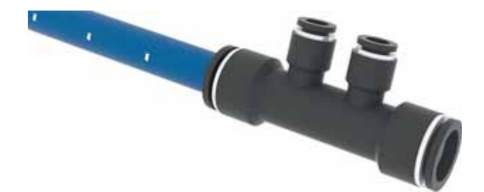
Po zmontowaniu istnieje możliwość obrócenia złącza, a po wciśnięciu pierścienia zabezpieczającego rurę można wysunąć. Podczas ponownego montażu rura musi zostać ponownie nasmarowana i sprawdzona pod kątem uszkodzeń.
