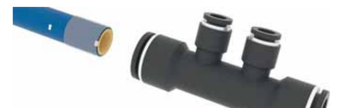
Koniec rury jest na szerokości 15 mm lekko nasmarowany smarem silikonowym do O-ringów.
