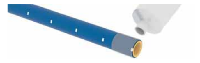
Koniec rury jest na szerokości 15 mm lekko nasmarowany smarem silikonowym do O-ringów.
